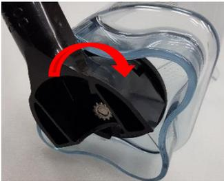
6 칼날 렌치를 이용하여 한 손으로 용기를 잡고 칼날 렌치를 이용하여 용기 바닥의 동그란 칼날 너트 홈에 맞추어 끼운 후 시계방향(화살표 방향)으로 돌려서 조립합니다. (칼날 너트를 덜 조이게 되면 진동소음 발생 및 용기에 균열이 발생될 수 있습니다.)
